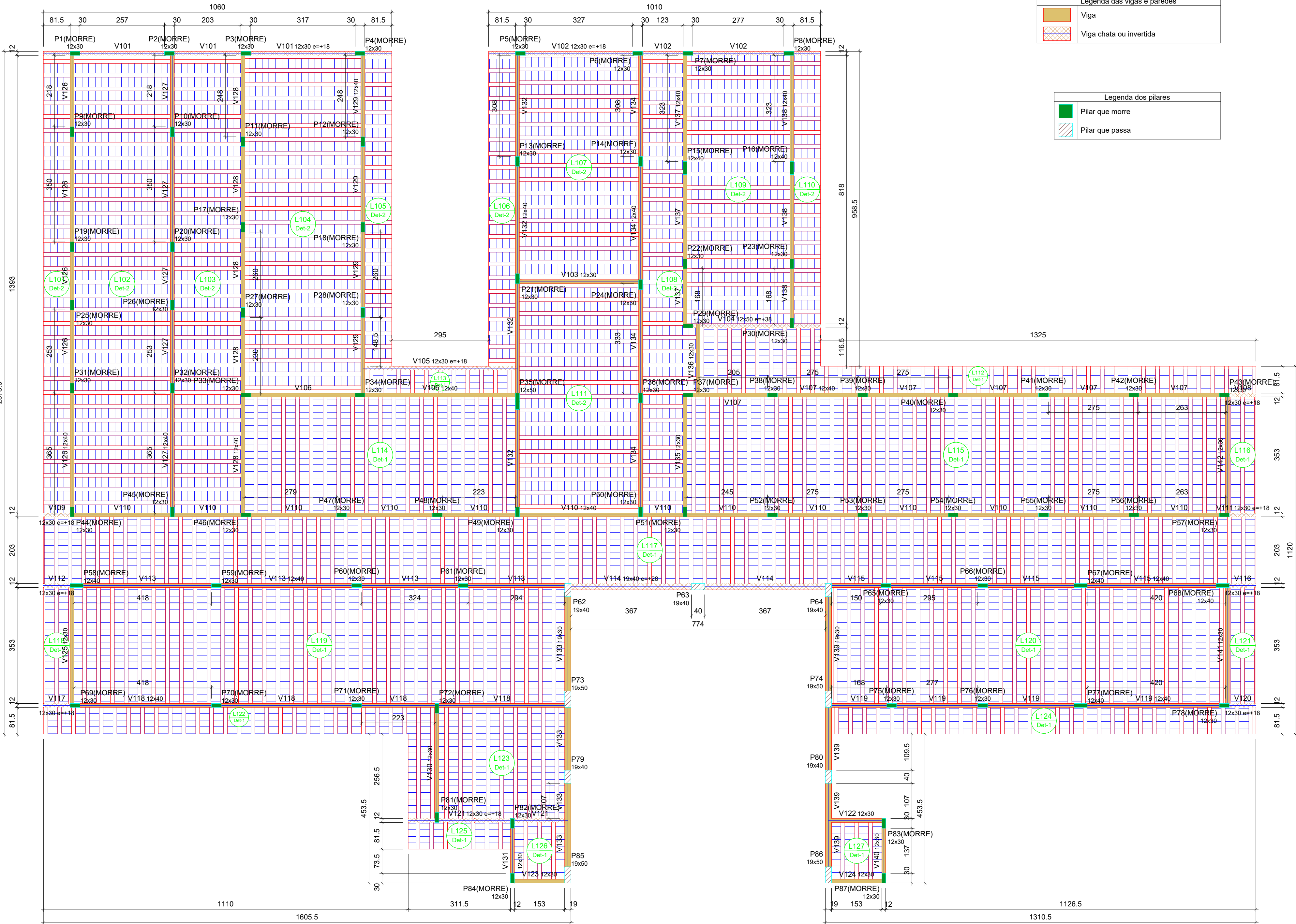
FORMA DO PAVIMENTO LAJE 01 (NÍVEL 335) Escala 1:75
